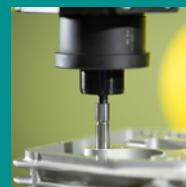
片ロプラグゲージで穴の 通り検査 Single ended Go and NoGo plug gauge
